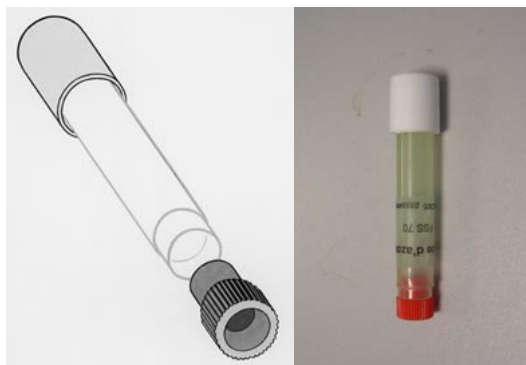
SCHEMA DESCRIPTIF DU TUBE A DIFFUSION TYPE "PALMES" (DETAIL)
