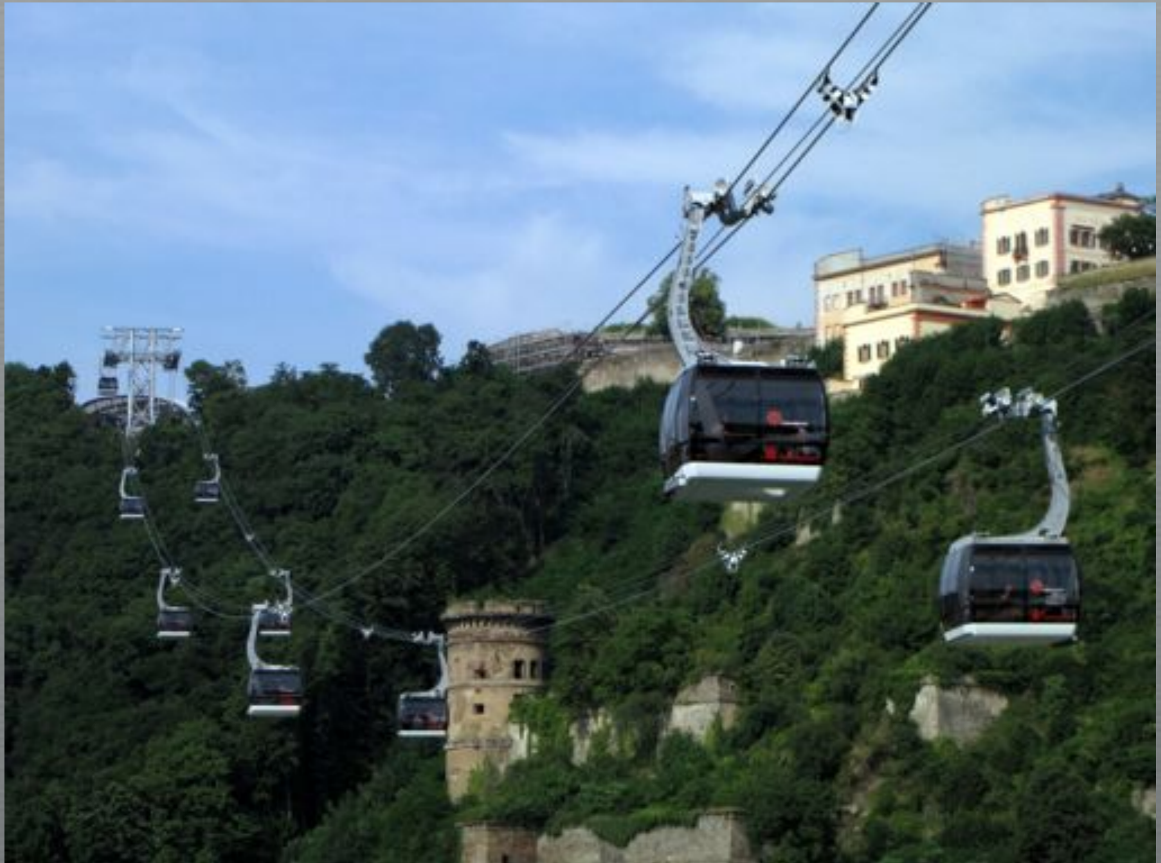
Un téléphérique 3S à Coblence utilisé pour franchir le Rhin
